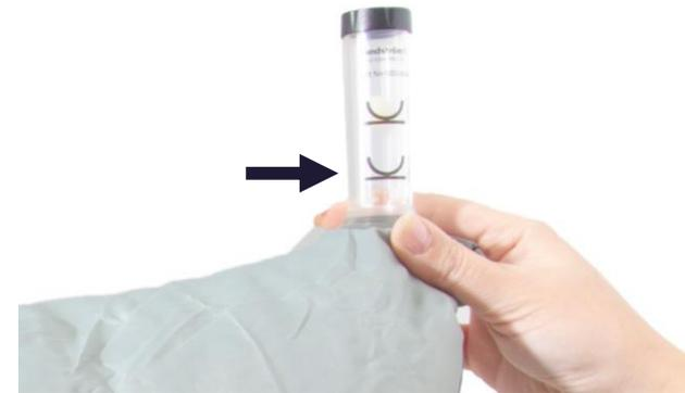
**2.2** Contrôlez la position de la bille dans le tube. Elle doit flotter au niveau voire légèrement au-dessus de la graduation sur le tube.
