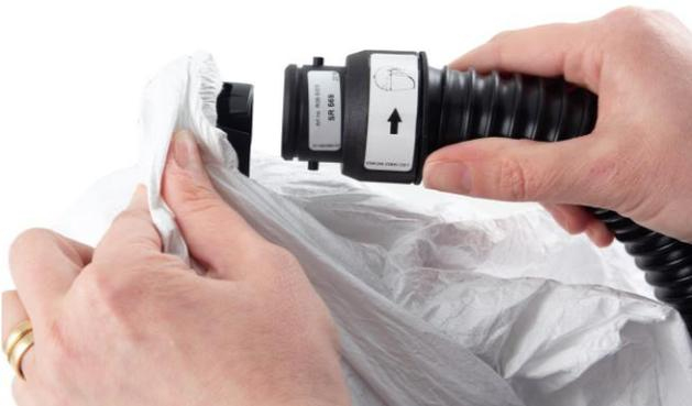
**6.3** Installez le nouveau flexible dans le jeu de brides dans l'ordre inverse. L'un des raccords de flexible est muni d'un joint torique. Cette extrémité doit être reliée à l'unité/au ventilateur à air comprimé.
