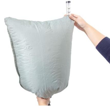
**2.2** Platzieren Sie das Kopfberteil in den Strömungsmesser, und fassen Sie den Beutel so unten an, dass er um den oberen Anschluss des Atemschlauchs abdichtet.
