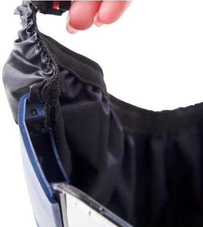
**6.4** Passen Sie die Gesichtsdichtung in den inneren Flansch des unteren Visierrahmens ein. Beginnen Sie auf einer Seite, drücken Sie den Stift nach oben und achten Sie darauf, dass die Lippe im unteren Visierrahmen befestigt ist. Drücken Sie am Rahmen der Gesichtsdichtung entlang, bis sie auf dem unteren Visierrahmen sicher sitzt. Achten Sie darauf, dass der Stift und die Lippe auf beiden Seiten befestigt sind.
