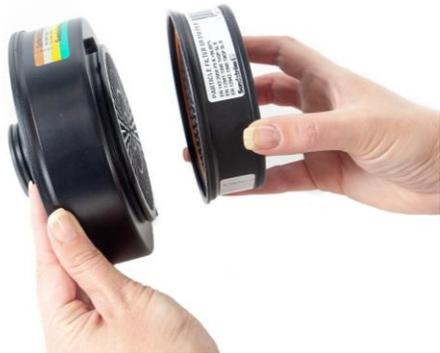
**12.4** Cambio del filtro de gases: desenrosque el filtro/filtro combinado. Para cambiar el filtro de gases, haga palanca en el filtro de partículas para extraerlo del filtro de gases.
