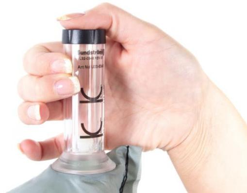
**10.1** Provoque la parada del flujo sujetando firmemente la junta entre la manguera y la bolsa del flujómetro y bloqueando la salida del flujómetro.
