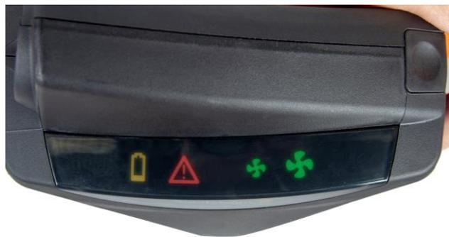
**6.2** Después de pulsar el botón, se realizará una prueba programada en el ventilador, la pantalla se iluminará y se oirá una señal sonora.
