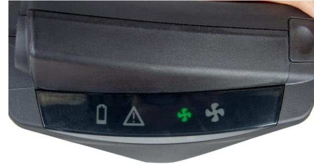
**6.3** Después de la prueba interna, se apagarán todos los símbolos menos el símbolo del ventilador verde pequeño. Este indica el estado de funcionamiento normal, con un flujo de 175 l/min como mínimo.
