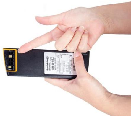
**13.4** Reinigen Sie die Dichtung auf der Batterie.
