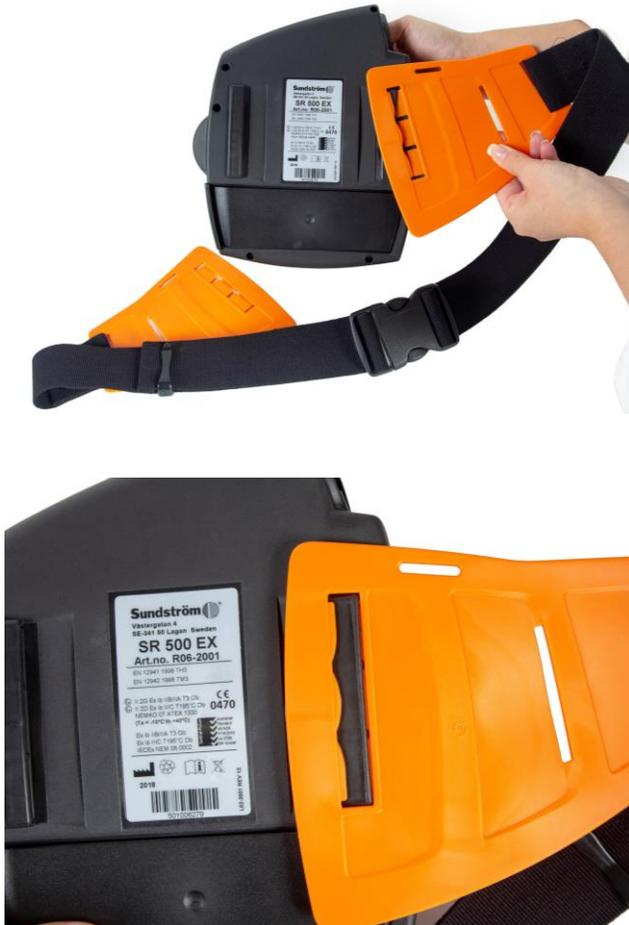
**3.1** Stellen Sie das Gebläse auf den Kopf. Der Gürtel muss so montiert werden, dass er nach oben weist. Setzen Sie die drei Zungen der Gürtelhälfte halb in den Schlitz des Gebläses ein.
