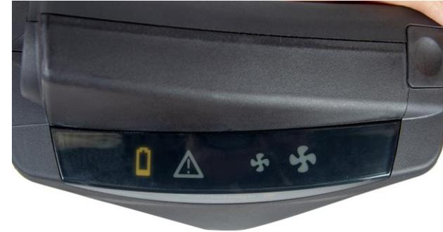
**6.5** Wenn die Batteriekapazität bis auf 5 % erschöpft ist, gibt das Gebläse einen Alarm aus, und das Batteriesymbol beginnt zu blinken. Die verbleibende Batteriekapazität reicht dafür aus, die gerade ausgeführte Tätigkeit ohne Hast zu beenden. Danach sollte die Arbeit unterbrochen werden, und der Träger der Ausrüstung hat die Baustelle zu verlassen.
