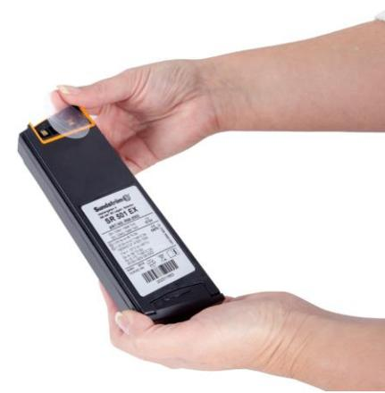
**1.2** Entfernen Sie das Klebeband, und laden Sie die Batterie.
