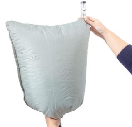
**9.3** Platzieren Sie die Gesichtsteil in den Strömungsmesserbeutel, und schalten Sie das Gebläse ein.
