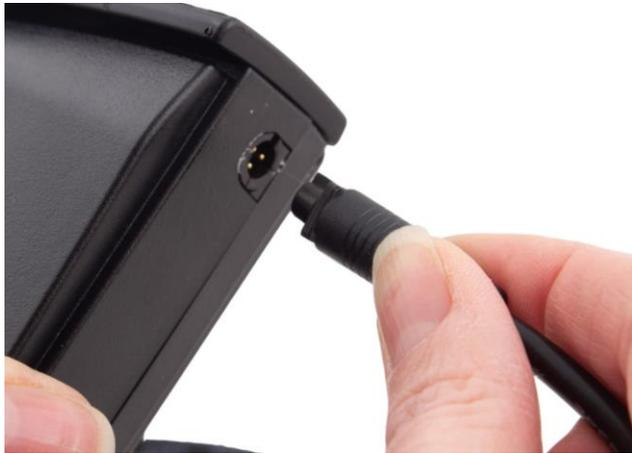
**2.1** Conecte la batería al cargador.
