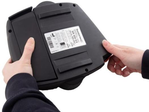
**1.1** Coloque el ventilador boca abajo.
