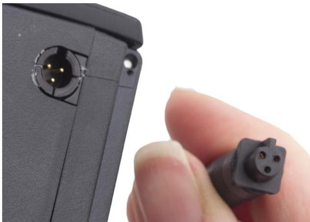
**2.2** Asegúrese de que la clavija del enchufe del cable esté encajada en la ranura de la batería.
