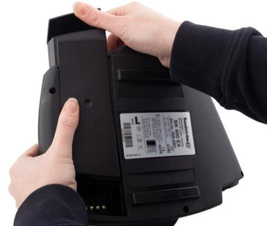
**1.2** Heben Sie die Batterieabdeckung einige Zentimeter an, schieben Sie die Batterie mit dem Daumen und ziehen Sie sie heraus.
