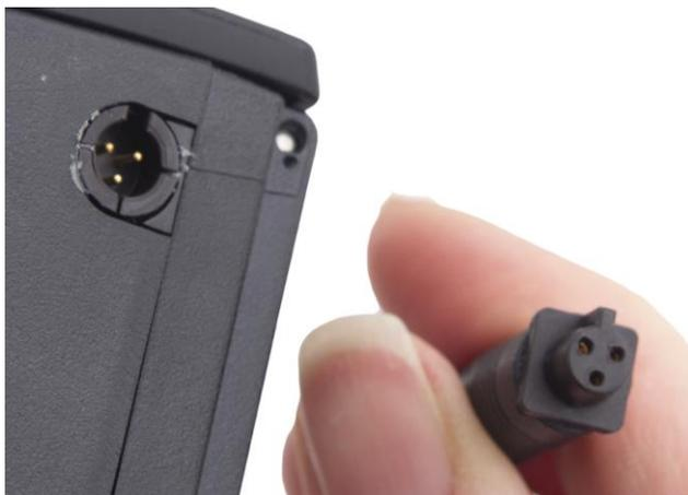
**2.2** Stellen Sie sicher, dass der Stift am Stecker des Kabels in der Nut der Batterie sitzt.
