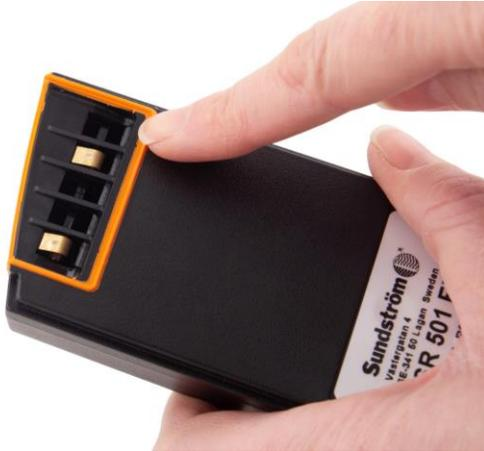
**3.1** Vergewissern Sie sich, dass die Dichtung um die Öffnung zu den Batteriepolen an der Unterseite der Batterie unbeschädigt ist.
