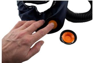
4.3 Pressez la nouvelle membrane sur la goupille.Vérifiez soigneusement que la membrane est complètement en contact avec le siège de la soupape.
