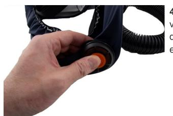
**4.4** Mettez le couvercle de la valve en place en appuyant dessus. Un clic indique qu'il est bien en place.
