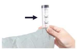
2.2 Placez l'équipement de protection respiratoire dans le débitmètre et démarrez le ventilateur. Serrez la poche pour assurer l'étanchéité autour du flexible respiratoire. Saisissez le tube du débitmètre avec l'autre main de manière à ce qu'il sorte verticalement de la poche.
