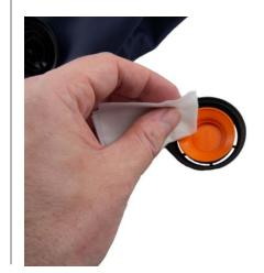
**6.6** Nettoyez le couvercle de la soupape à l'intérieur et à l'extérieur.
