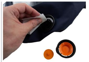
**6.5** Nettoyez le siège de la soupape et vérifiez que ce dernier est en bon état.
