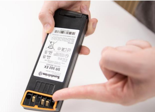
**2.1** Antes de su uso, compruebe que la junta situada alrededor de la abertura de los terminales de la batería no presente daños.
