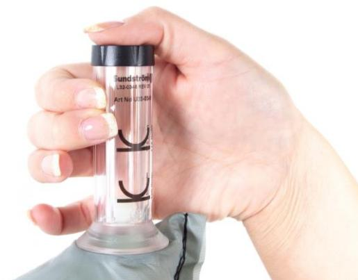
**8.1 Provoque la parada del flujo sujetando firmemente la junta entre la manguera y la bolsa del flujómetro y bloqueando la salida del flujómetro.**
