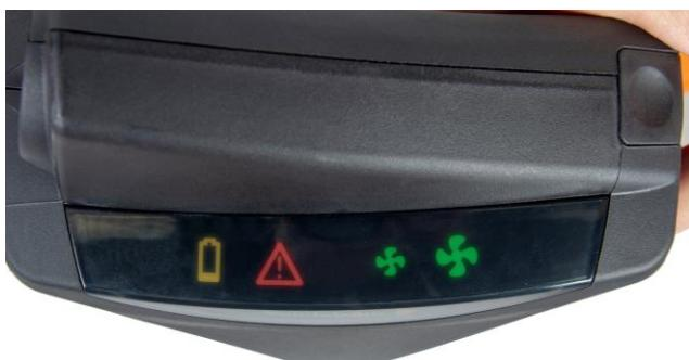
**6.2** Despues de pulsar el botón, se realizará una prueba programada en el ventilador, la pantalla se iluminará y se oirá una señal sonora.
