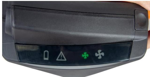
**6.3** Despues de la prueba interna, se apagarán todos los símbolos menos el símbolo del ventilador verde pequeño. Este indica el estado de funcionamiento normal, con un flujo de 175 l/min como mínimo.
