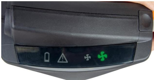
**6.4** Si vuelve a pulsar el botón, se activará el estado de funcionamiento de potencia alta, con un flujo de 225 l/min como mínimo. Esto se indica con el encendido del símbolo del ventilador verde grande.
