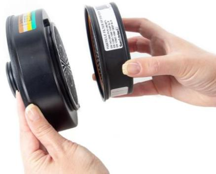
**10.4** Cambio del filtro de gases: desenrosque el filtro/filtro combinado. Para cambiar el filtro de gases, haga palanca en el filtro de partículas para extraerlo del filtro de gases.
