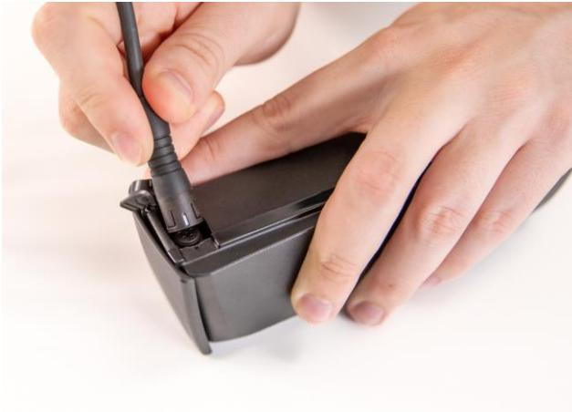
**1.3** Conecte la batería al cargador de batería. Conecte el enchufe del cargador a una toma de corriente.
