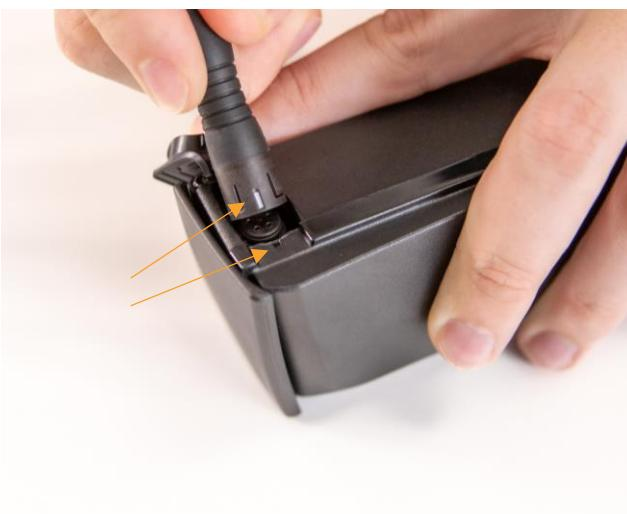
**1.4** Asegúrese de que la marca blanca del conector esté alineada con la marca de la conexión de la batería.
