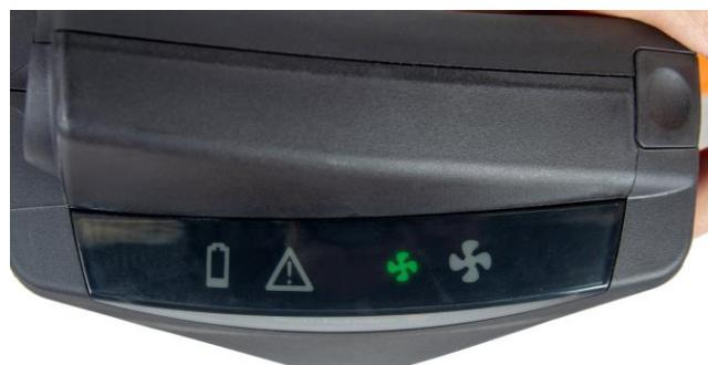
**8.3 Si se libera el flujómetro y se deja fluir el aire libremente, las señales de alarma pararán en 10-15 segundos.**
