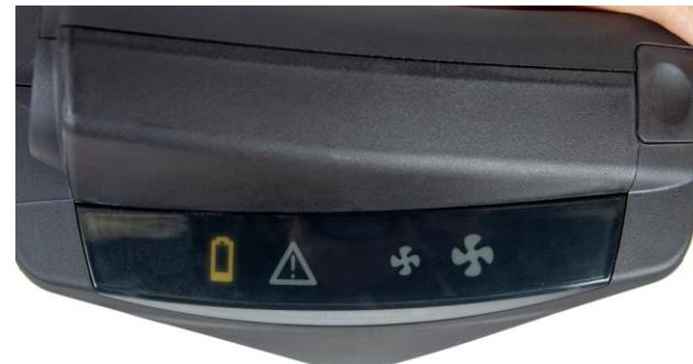
**6.5** Si la carga de la batería tiene aproximadamente el 5-10 % de la carga original, se indica de la siguiente manera:
