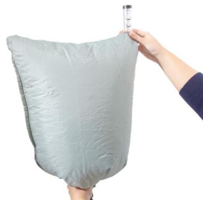
**7.3** Coloque el equipo facial en la bolsa del flujómetro y encienda el ventilador.
